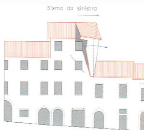
Comportamento di edifici a schiera per sollecitazioni sismiche parallele al prospetto.
