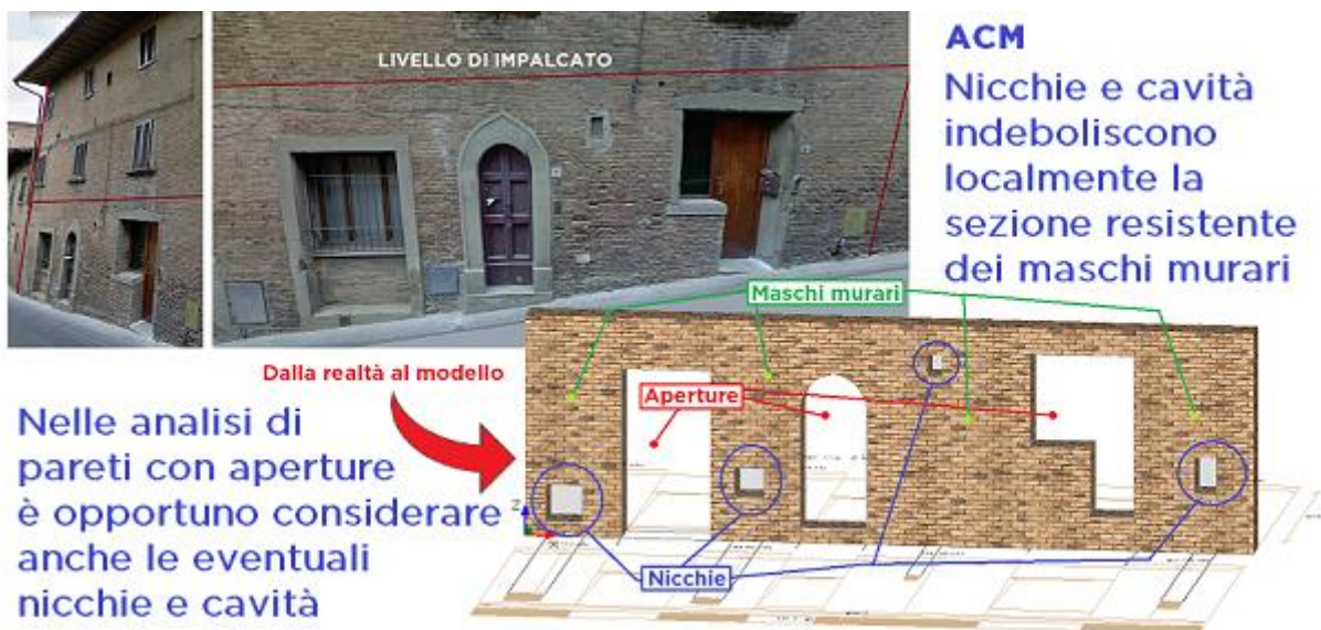
Fig. B.6.17. Nicchie e cavità in pareti murarie
