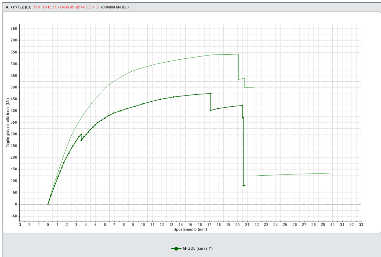
Figura 123. Curva Pushover: con componente sismica verticale (linea spessa) e senza (linea sottile)
