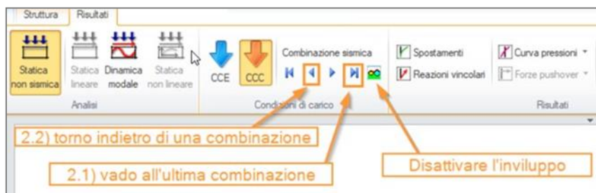
Figura 243. Combinazione sismica in Analisi statica non sismica
