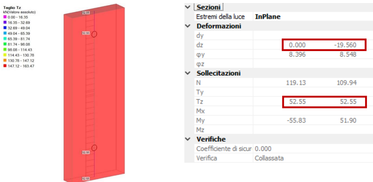
Figura 52. Modalità di crisi e valori del taglio resistente e dello spostamento del pannello E4
