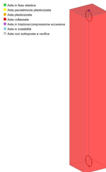
Figura 24. Crisi a pressoflessione duttile del pilastro e cerniere plastiche di base e sommitale
